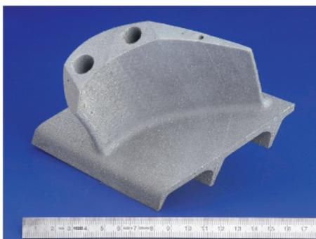
Turbinschaufel für aerodynamische Untersuchungen mit integrierten Messkanälen
