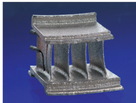
Leitschauflensegment mit integrierten Messkanälen (mit freundlicher Genehmigung von MTU)
